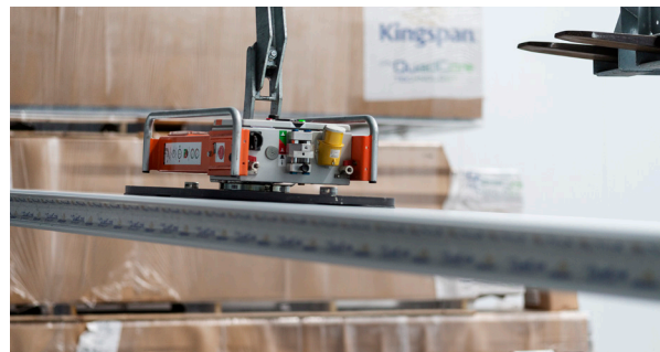
Rys. 19. Ustawienie podnośnika na wierzchniej/pierwszej płycie.
