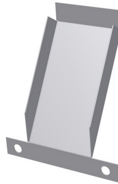
Rys. 69. Korytka odwadniające dla obróbek K175 „Top-hat” (dół) i przykładowe miejsce instalacji (góra)
