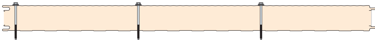
Rys. 44. Zalecane miejsce osadzenia łączników dla płyt ściennych z widocznym mocowaniem.
