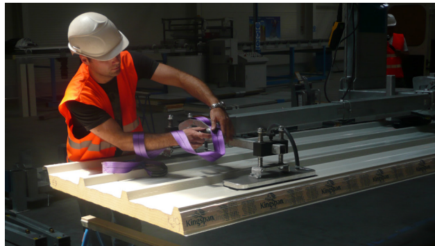
Rys. 22. Płyta warstwowa obrócona na stojakach
