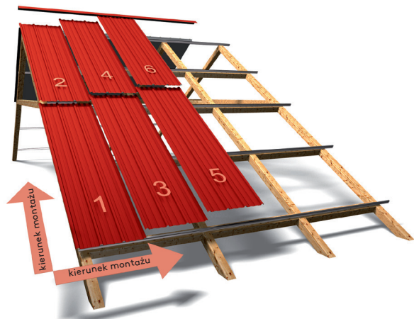
Rys. 51. Kierunek i kolejność montażu płyt dachowych
