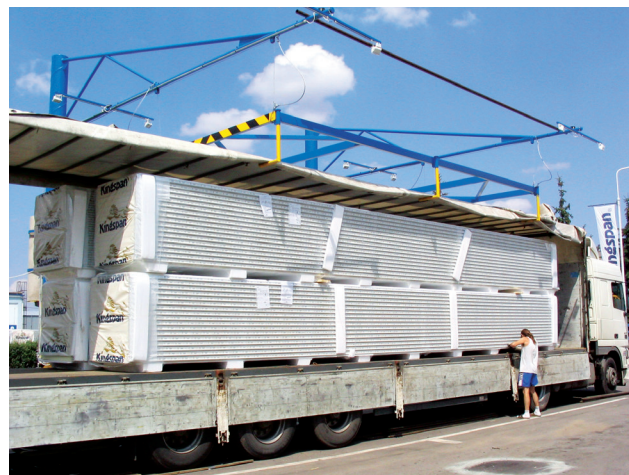
Rys. 2. Transport piętrowanych paczek.
